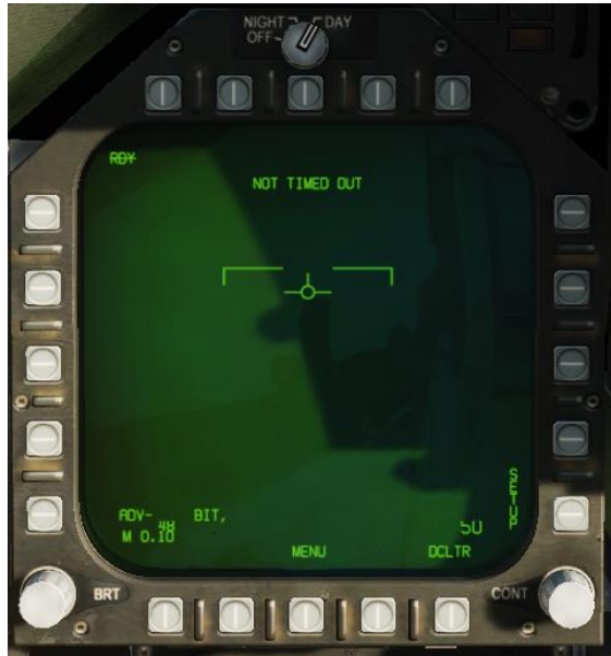
图 103. NOT READY 模式下的 ATFLIR 页面
